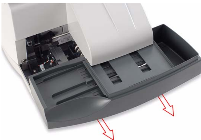
Figur 6-1: Fjerne den stasjonære plattformen
