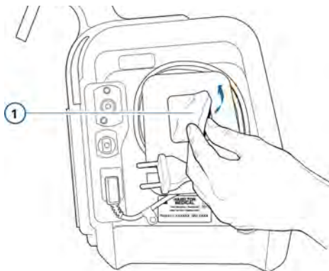
Figur 10-1. Fjernelse af ventilationsfilteret (1)
