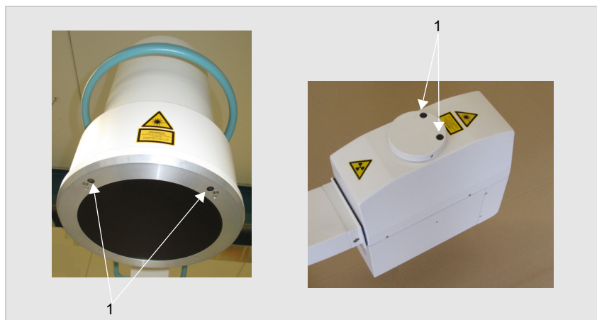
Fig. 3-1 Laserstråle-utgangsåpning (1) på bildeforsterkeren (venstre) og generatoren (høyre) (Ziehm Vision)
