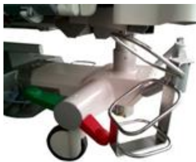
Fig. Oksygenflaskeholder B – feil montering
