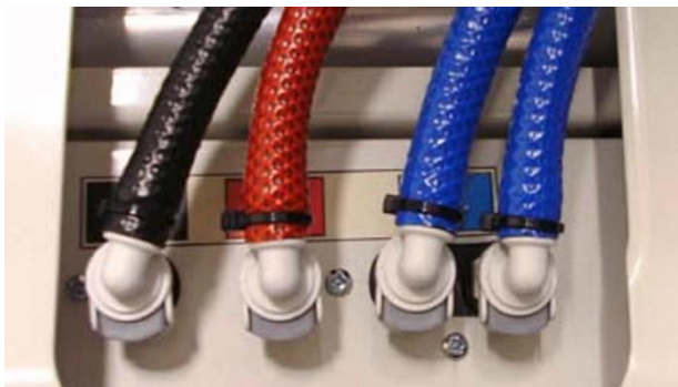
Fig. Fargekodede luftslanger
