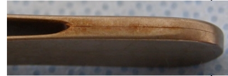
Spalt korrosjo n
