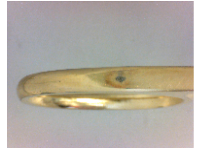
Kontakt korrosjo n
