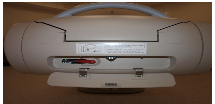
Figur 4: Hendel står her i normal stilling mot høyre. Hendelen trekkes mot venstre for å låse opp bordet i longitudinal retning
