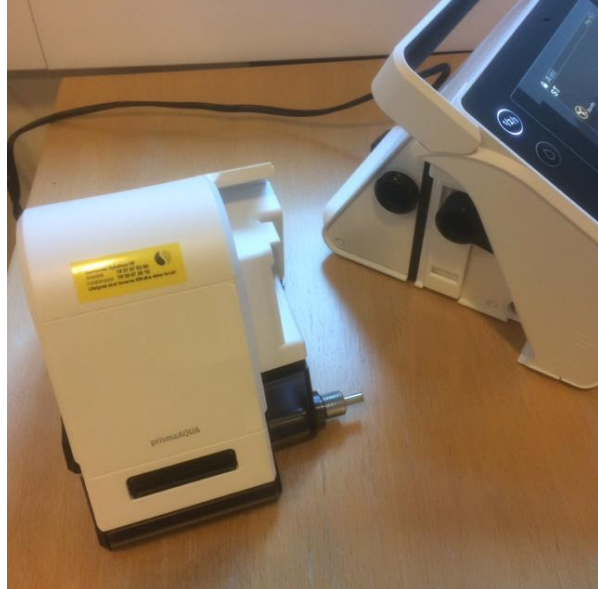
Varmefukter er klar til å settes på maskinen. Før delene sammen til man hører et klikk.
