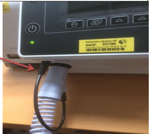
Tilkobling for slange. Hvis bruk av varmfukter, bruk slange med varmesensor. Varmesensor kobles til maskinen her
