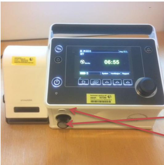
Slangetilkobling – og tilkobling for varmesensor på slange som skal brukes når pasienten har varmfukter tilkoblet. Slangen vaskes x 2 pr uke i steril/ kokt såpevann, skylles og henges til avrenning.
